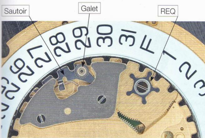
Fig. 3: Système CQP. En haut à gauche : sautoir à galet roulant sur la denture disque. En haut à droite : REQ centrée dans la zone morte.
